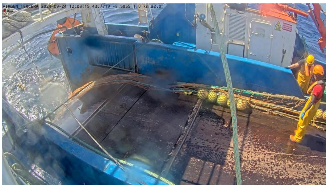
Figura 11. “Pinger” modelo Banana instalado en la relinga de corchos del aparejo de gran abertura durante la largada.
