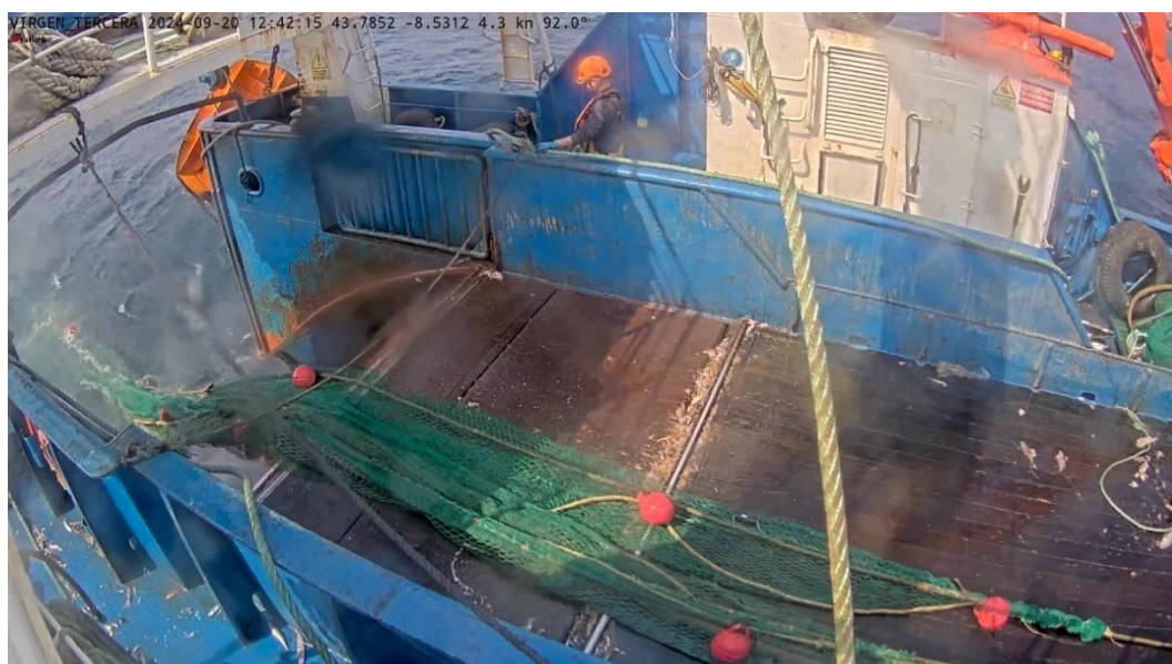
Figura 12. “Pinger” modelo Marexi instalado en la relinga de corchos del aparejo de fondo durante la largada.
