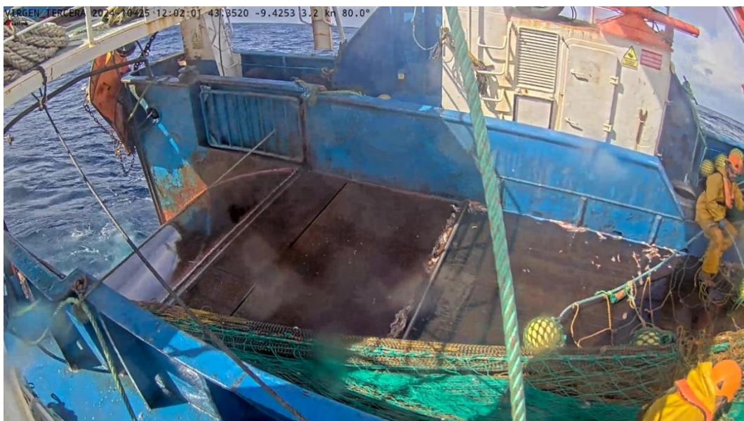
Figura 14. “Pinger” modelo DDH03 instalado en la relinga de corchos del aparejo de gran abertura durante la largada.
