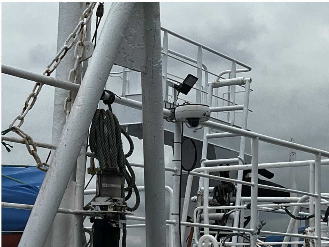
Figura 8. Cámara de video situada en estribor hacia la cubierta de pesca.
