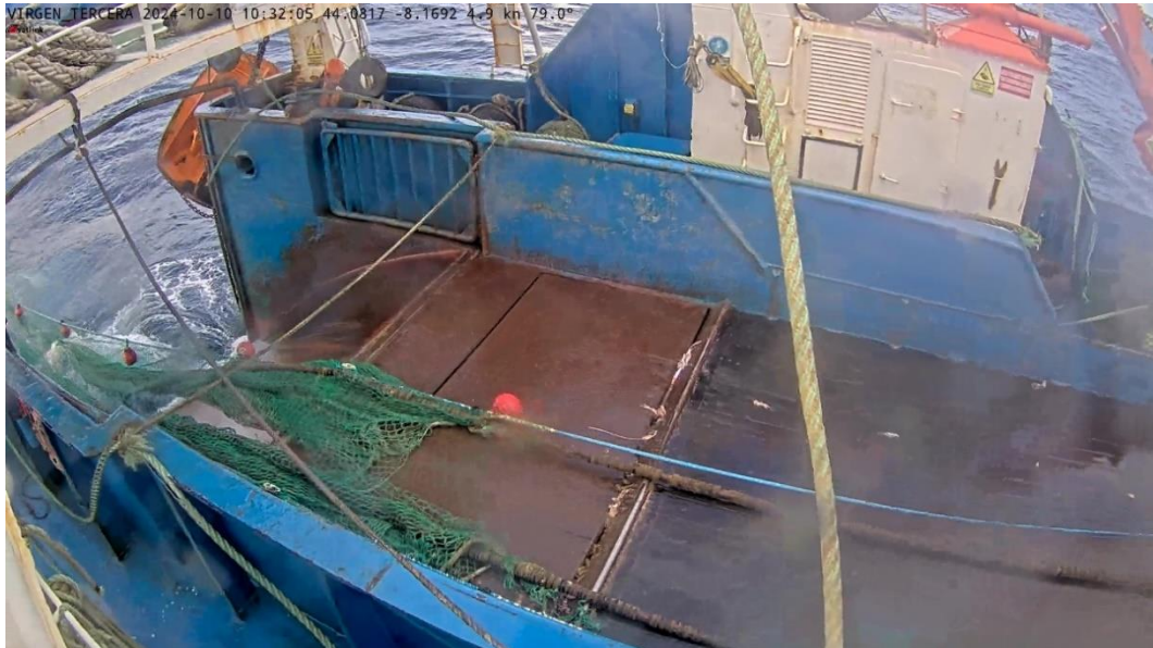
Figura 13. “Pinger” modelo Netguard instalado en la relinga de corchos del aparejo de fondo durante la largada.
